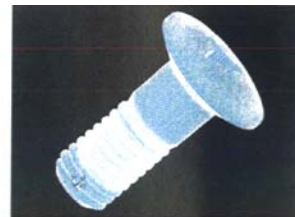
图 3 螺栓有限元模型 Fig.3 Finite element model of bolt
